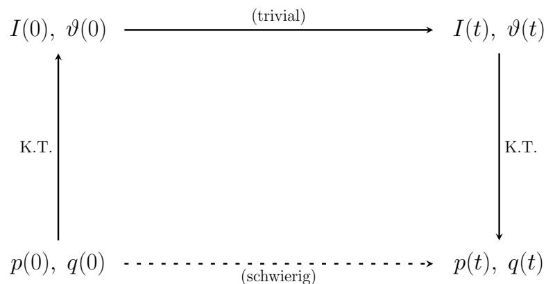
Abbildung I.17: Lösung integrabler Systeme. Nach einer kanonischen Transformation der Anfangswerte auf Wirkungs- und Winkelvariablen wird die Zeitentwicklung des Systems in einfacher Weise durch Gleichung (I.2.113) beschrieben; Umkehrung der Transformation liefert dann den gesuchten Endpunkt der Phasenraumtrajektorie.
